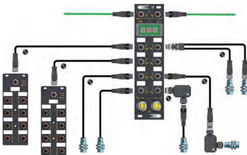
IO-link连接技术示意图
